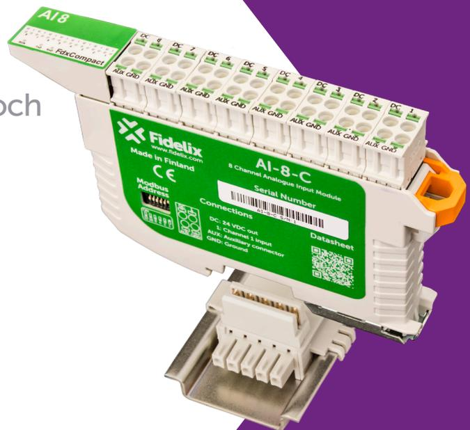
**Strömförsörjning och kommunikation:** Strömförsörjning och kommunikationsbussen ansluts till AI-8-C-modulen via en kontakt som monteras i DIN-skenan. FdxCompact styrenheten kan försörja DIN-skene kontaktarna direkt, eller så kan Fdx-terminal-C användas. Den mellersta kontakten är internt ansluten till 0 VDC IN.
